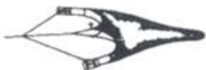
Rede de arrasto "língua": cabo de pana e arraçal com duas secções
